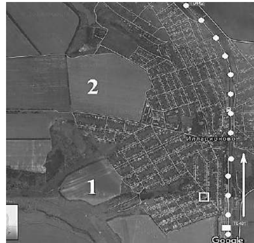
Рис. 1. Вид расчетной области: 1 – поле; 2 – поле; точки – положение железной дороги; сплошной прямоугольник на железной дороге – место начала эмиссии опасного вещества; прямоугольник в поселке – место положения рецептора
