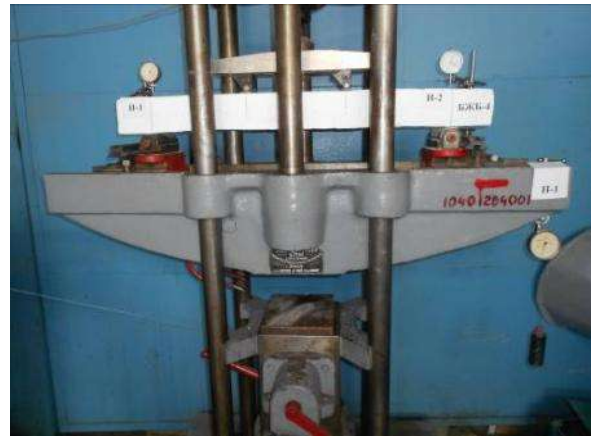
Рис.6. Испытание опытных образцов балок при «чистом изгибе» на универсальной испытательной машине УИМ 50
