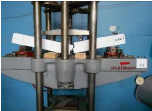
Рис. 13. Разрушение опытной балки по нормальному сечению в зоне «чистого изгиба»
