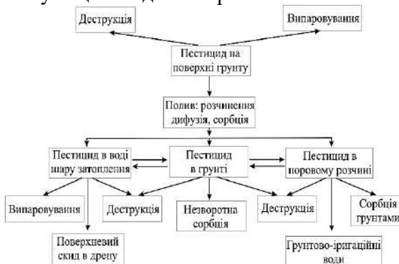
Рис. 2. Схема поведінки пестициду на рисовому чеці при поверхневому внесенні засобів захисту рослин
