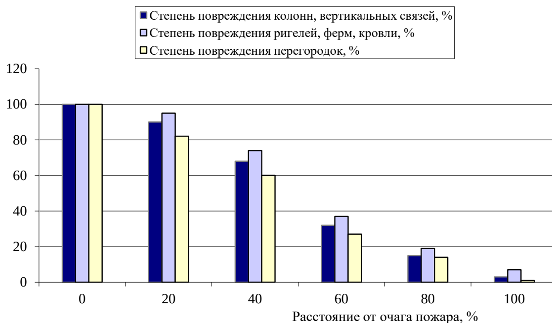
Рис. 3. Обобщение статистических данных после воздействия высокой температуры на разные группы конструкций
