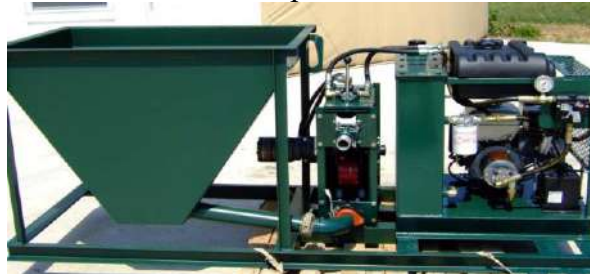
Рис. 4. Шланговий бетононасос GHP 1500 з бензиновим двигуном Honda
