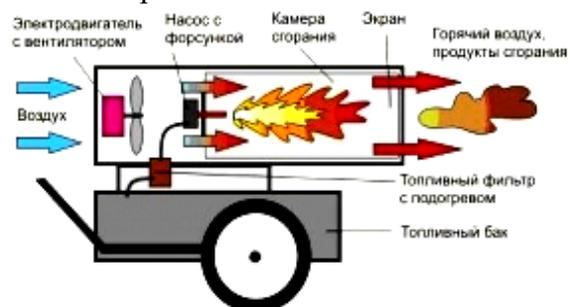
Рис. 2. Принципиальная схема устройства и принципа работы жидкотопливной тепловой пушки с прямым нагревом воздуха.
