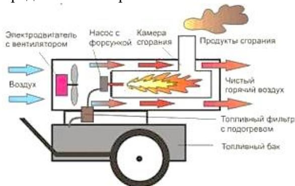
Рис. 4. Принципиальная схема устройства и принципа работы жидкотопливной тепловой пушки с непрямым нагревом воздуха.
