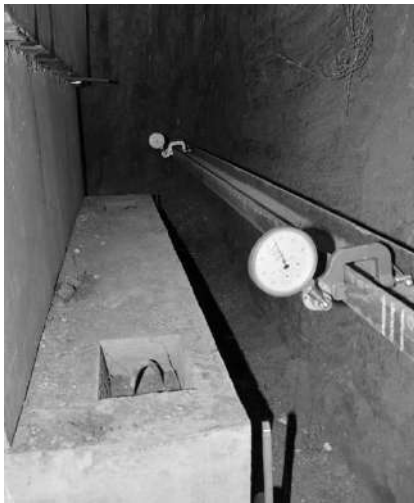
Рис. 2. Определение осадок штампа-2,0м² с помощью прогибометров БПАО, расположенных на реперной системе
