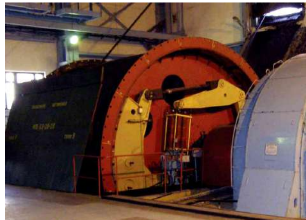
Рис. 1. Канатний підйомник з розрізним барабаном і вбудованим гальмовим пристроєм
