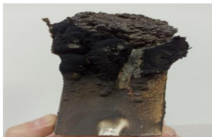
Рис. 3. Зовнішній вигляд зразка та інтумесцентного покриття після випробувань.
