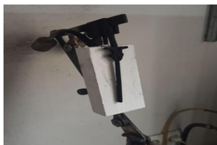
Рис. 2. Спосіб кріплення зразка в установці ОТМ.
