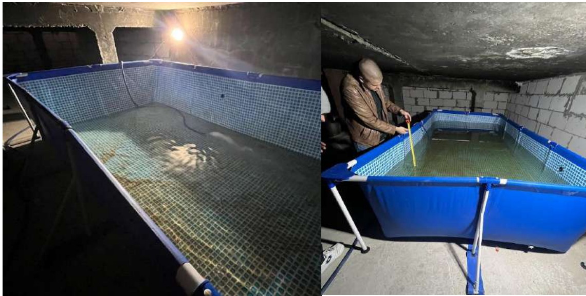
Рис. 8. Процедура навантаження панелі перекриття
