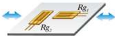
Рис. 3 - Схема наклеювання датчиків на поверхню барабана
