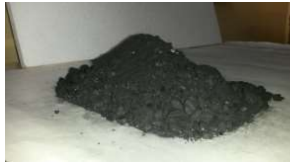
Рис. 1. Модель штабеля угля
