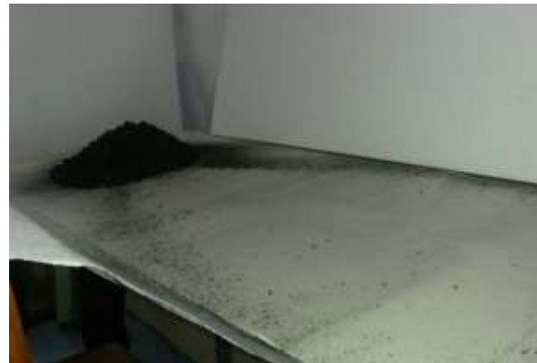
Рис. 2. Зона загрязнения возле модели штабеля угля (нет защитных экранов)
