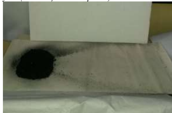
Рис. 3. Зона загрязнения возле модели штабеля угля (нет защитных экранов)
