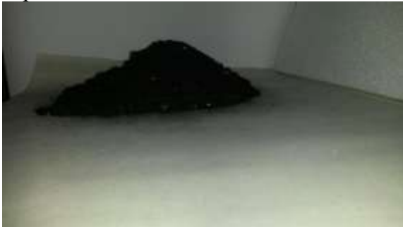
Рис. 4. Зона загрязнения возле модели штабеля угля при покрытии его поверхности специальным раствором
