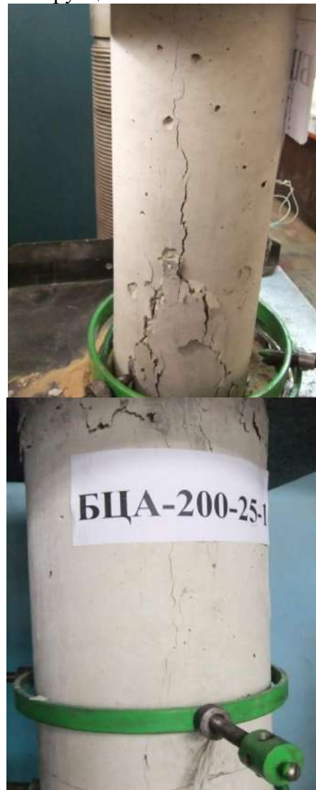
Рис. 9. Характер разрушения стеклопластбетонных образцов при сжатии
