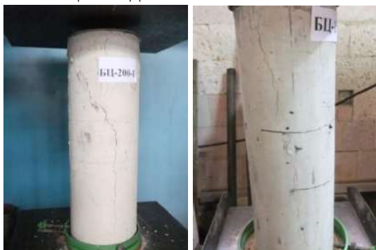
Рис. 6. Характер разрушения образцов серии БЦ-200 и БЦ-150
