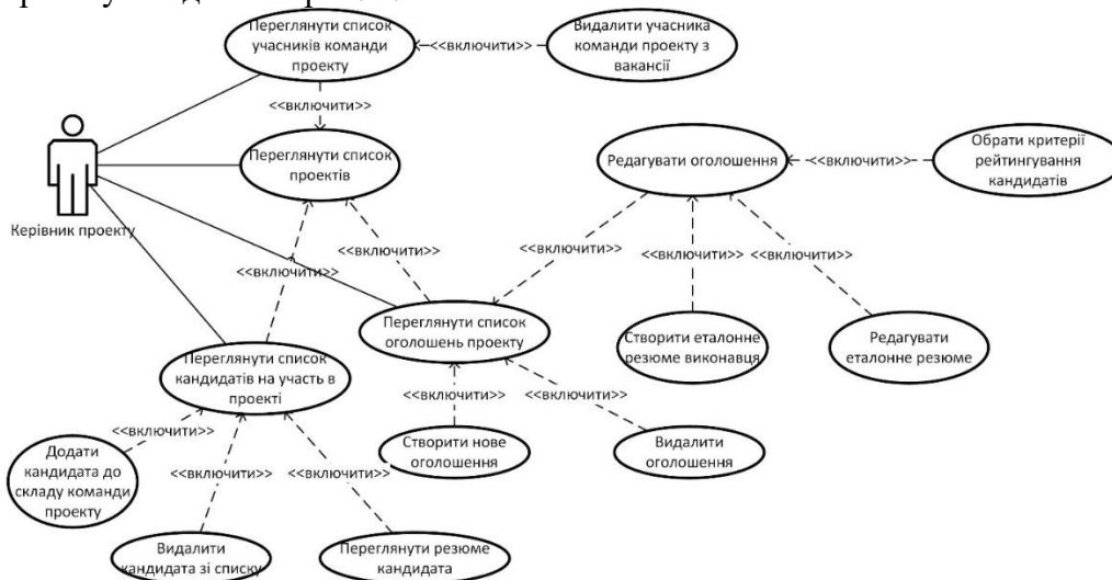
Рис. 2. UML діаграма варіантів використання (керівник проєкту)
