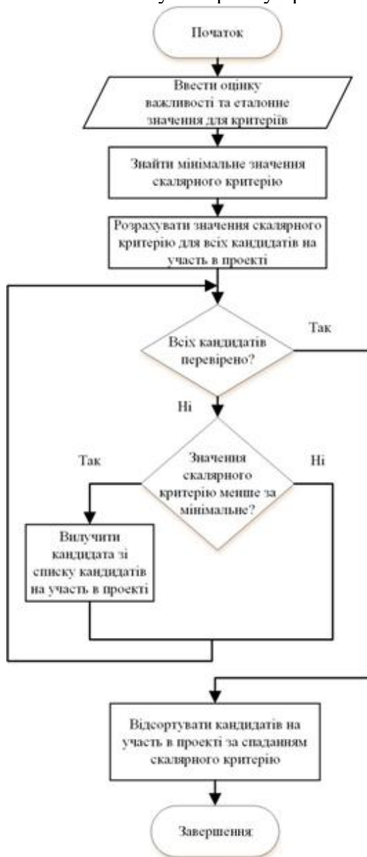
Рис. 5. Блок-схема алгоритму пошуку рекомендацій для користувача
