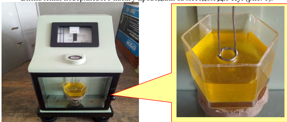
Рис. 1. Визначення поверхневого натягу інтумесцентного покриття
