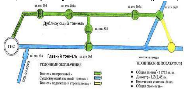
Рис. 6. Схема строительства Главного дублирующего коллектора.
