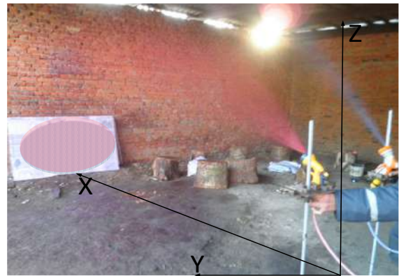
Рис.4. Подача ОС: а) – схема расположения стволов распылителей двумя компактными струями при их неподвижном размещении; б) – подача ГОС плоскорадиальными веерными струями при неподвижно закреплёнными стволами-распылителями
